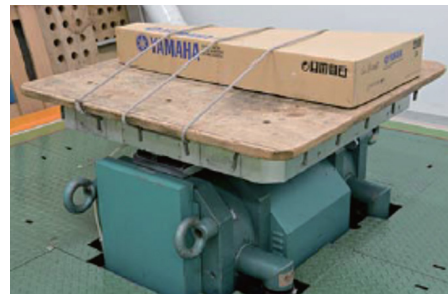
트럭 운송 환경을 시뮬레이션하기 위해 강도 높은 진동 테스트를 받는 기타
