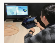
컴퓨터를 이용한 브레이싱의 두께와 배열 시뮬레이션.
