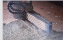
FG9 브레이싱 형성 과정 (CNC 가공)
