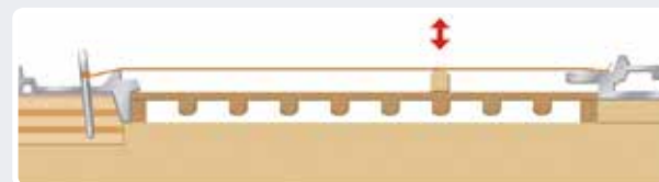
Sección de Tabla Armónica que ha perdido la corona
