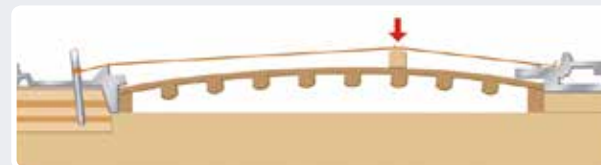
Sección de Tabla Armónica con corona.
