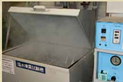
電鍍件接受腐蝕性鹽霧測試
