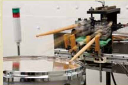
長期的耐用性測試以確保我們的鼓可以撈過大量使用
