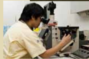
顯微鏡檢查電鍍層厚度及品質
