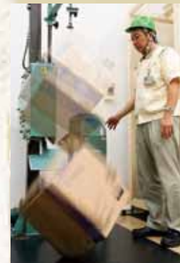
跌落測試確保我們的包裝可以防止樂器在最惡劣的情況下損壞
