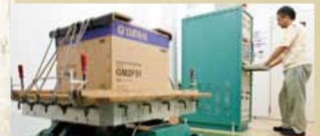
震動測試確保在運送至全世界的過程中不會發生損傷
