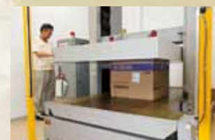
壓縮測試模擬包裝再疊壓時所承受的壓力
