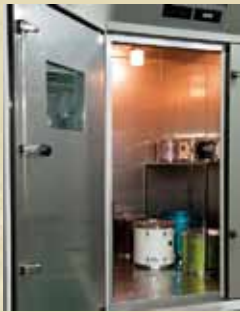
測試產品極端的熱、冷以及濕度加速的環境測試間
