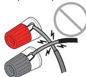
– No permita que los hilos expuestos del cable del altavoz entren en contacto con las partes metálicas de la unidad (panel trasero y tornillos).
