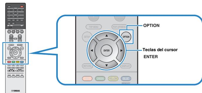
**3** Utilice las teclas del cursor para seleccionar “Audio In” y pulse ENTER.
