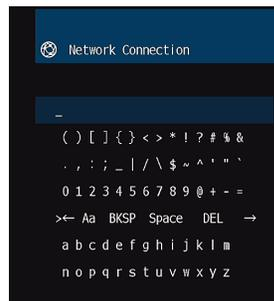
**4 Cuando termine de introducir la clave, utilice las teclas del cursor para seleccionar “OK” y pulse ENTER.**
