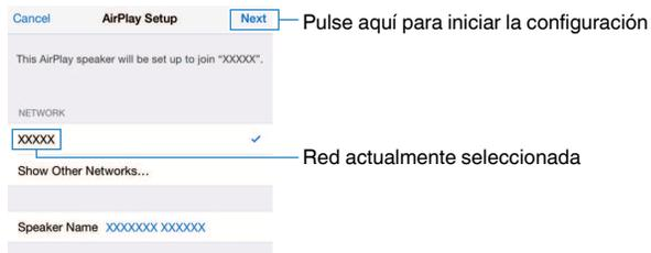
Cuando el proceso de compartición termine, la unidad se conectará automáticamente a la red seleccionada (punto de acceso) y aparecerá en el visor delantero el mensaje "Completed".
