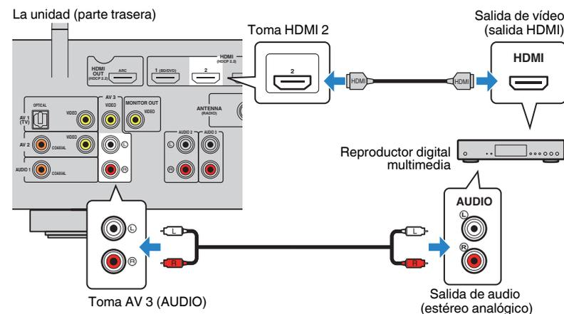
**1** Pulse HDMI2 para seleccionar “HDMI2” (toma de entrada de vídeo que se va a utilizar) como fuente de entrada.
