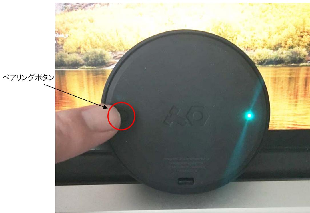
【ortho remote ペアリングボタンとLED(背面)】
