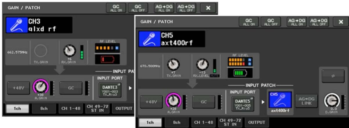
パッチしたポートにヘッドアンプがある場合、GAIN/PATCH ポップアップ画面には入力の A.GAIN とワイヤレスレシーバーのゲイン・レベルが両方表示されることにご注意ください。また AXT400 から AES/EBU で接続した場合、A.GAIN は表示されません。
