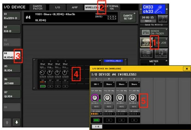
さらに、コンソールの入力チャンネルからワイヤレスマイクを直接操作することもできます。ただし、あらかじめ入力ポートを入力チャンネルにパッチしておく必要があります。Dante 機器では、Dante 入力ポートを入力チャンネルにパッチするだけなので簡単です。
