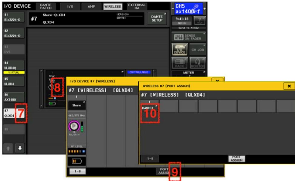
その後、上記で選択した入力ポートを入力チャンネルにパッチすると、チャンネル上にワイヤレスレシーバーの設定が表示されます。下図の例では、QLXD4 を Dante ポート 3 にパッチし、このポートを入力チャンネル 3 にパッチしています。また、AXT400 レシーバーを Dante ポート 5 にパッチし、このポートを入力チャンネル 5 にパッチしています。
