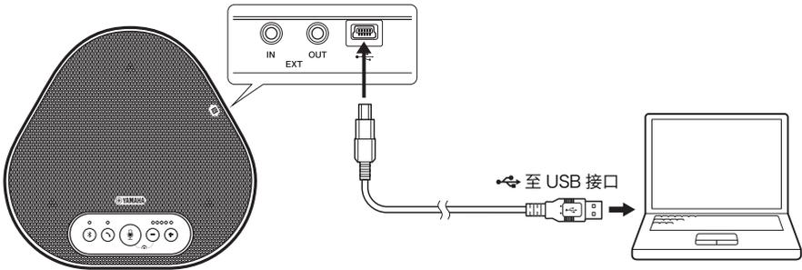
如果无法连接 PC / Mac，请使用附带的 USB 线将 USB 电源适配器（市售）接入 USB 接口。
