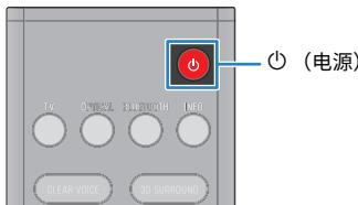
打开条形音箱时，所有指示灯均会亮起，然后，某些指示灯仍然亮起以显示设置状态（正常显示）。
