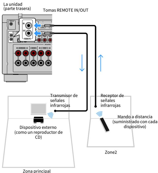
No necesitará un transmisor de señales infrarrojas si utiliza productos Yamaha compatibles con conexiones remotas, como es el caso de la unidad. Puede transmitir señales del mando a distancia conectando las tomas REMOTE IN/OUT con cables con toma mini monoaurales y un receptor de señales infrarrojas.
