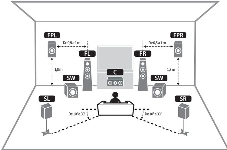
■ Para una disposición con altavoces de presencia delanteros en la posición superior
