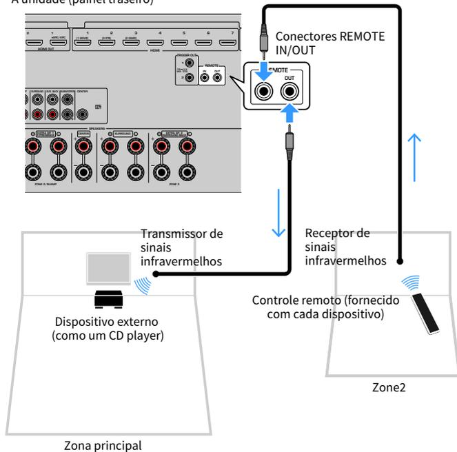
Um transmissor de sinais infravermelhos não é necessário se você usar produtos Yamaha que suportam conexões remotas, como a unidade suporta. Você pode transmitir sinais de controle remoto conectando os conectores REMOTE IN/OUT com cabos com mini-plugue monaural e um receptor de sinais infravermelhos.
