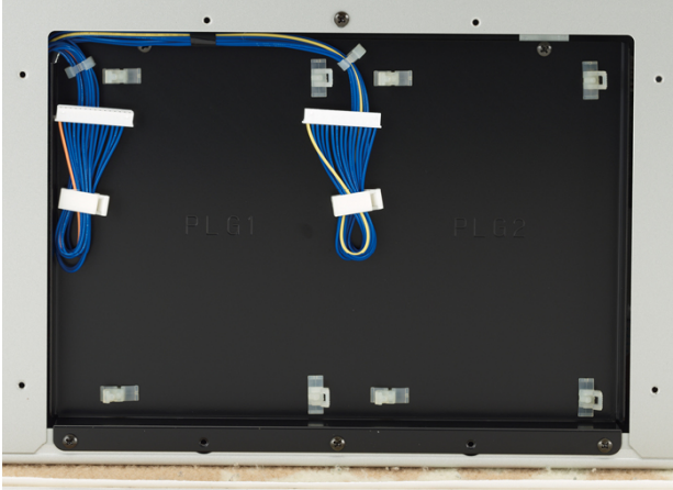
プラグインボードを2枚増設可能な「CS6x」裏面の拡張スロット
