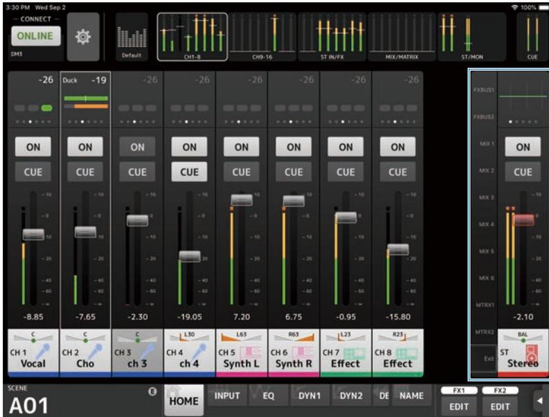
Sie können in den SENDS ON FADER-Modus schalten, indem Sie eine auf der linken Seite des Kanalzugs angezeigte Kanalnummer antippen. Der ausgewählte Kanal wird dann in der Farbe des Kanals hervorgehoben dargestellt. Durch Antippen von EXIT ganz unten, oder aber der gewählten Kanalnummer, wird der normale Modus wiederhergestellt.
