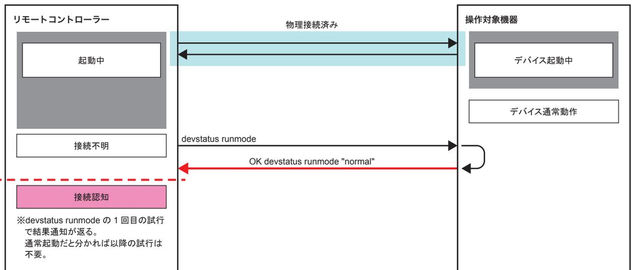
コントローラー側からの `devstatus runmode` 要求を試行することで起動判断ができています。
