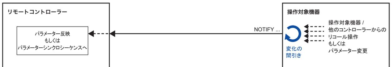
なお、パラメーター変更通知については、外部制御プロトコル動作モードで設定した値通知モードによって通知のされ方が異なる。
