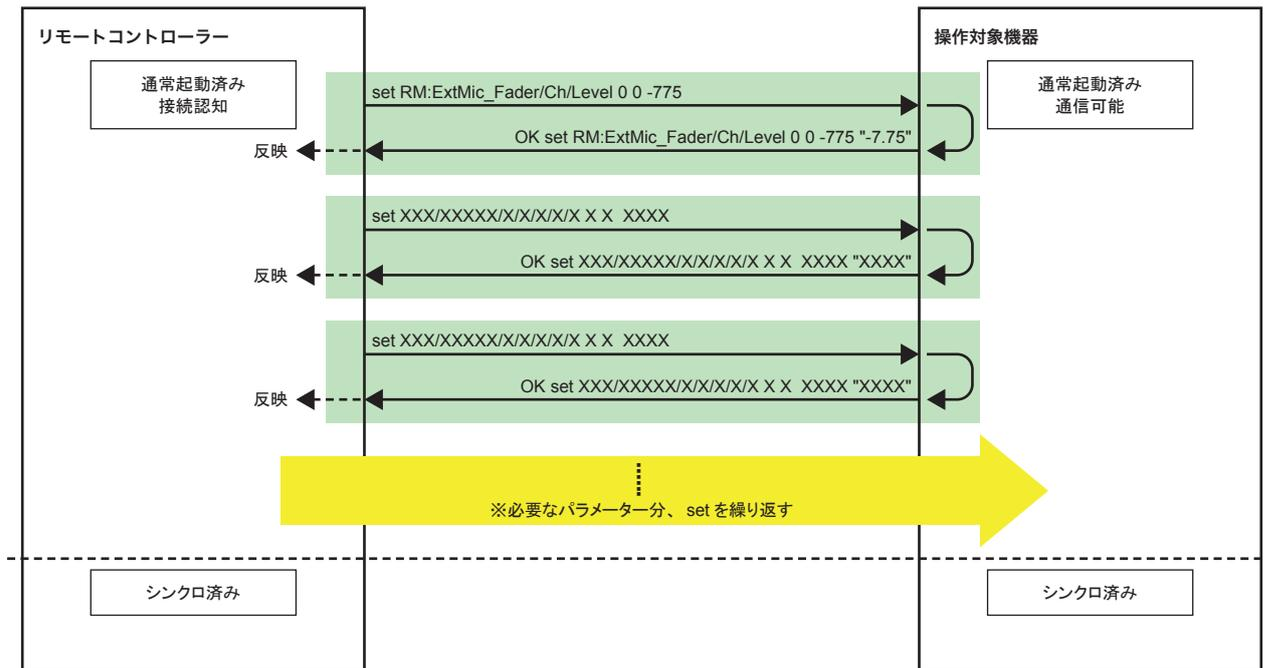
コントローラー側の最新状態を反映した場合も、状況によっては操作対象機器側で値が丸め込まれる可能性があるため、必要に応じて結果通知の内容を元にコントローラー側に再度反映する。
