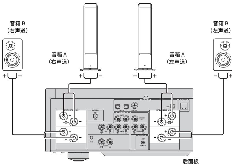
**1 剥去喇叭线端部约 10 mm 的绝缘皮，并将其线芯紧捻在一起。**
