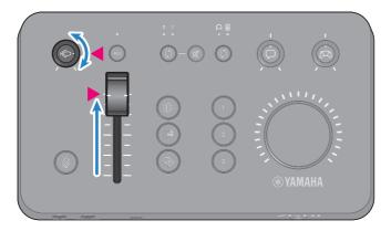
È possibile usare Yamaha ZG Controller per verificare i livelli d'ingresso/uscita del microfono. Regolare il livello d'ingresso (MIC LEVEL) e il livello d'uscita (OUT LEVEL) mentre si verificano gli indicatori di livello nella schermata "MIC SETTINGS", in modo che i livelli rientrino nell'intervallo "OK".
