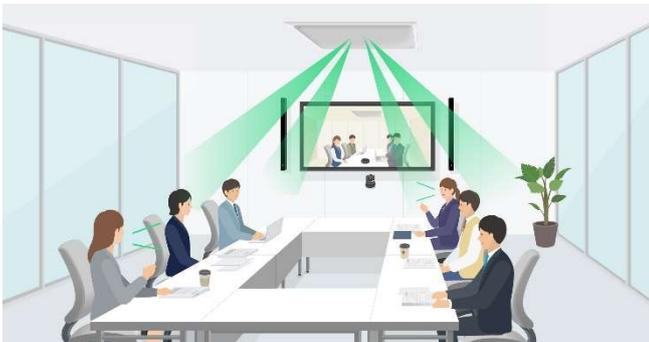
「ADECIA」は遠隔会議を行う部屋に最適なマイクロフォンやスピーカーを一式揃って導入いただけるシステムです。遠隔会議やハイブリッド型の授業を行う部屋を作りたいと考えた際、最適な音響機器がヤマハ製品で全て揃うため、何を導入すれば良いのかというお悩みを解決します。天井設置型のシーリングアレイマイクロフォン「RM-CG」を組み合わせた ADECIA シーリングソリューションは、明瞭な音質での收音と、机の上にマイクロフォンやケーブルの無いすっきりした内装が実現でき、快適な遠隔会議室をご提案します。
