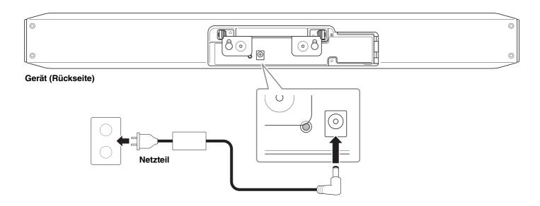
Durch Anschließen des Netzteils wird dieses Gerät automatisch eingeschaltet.
