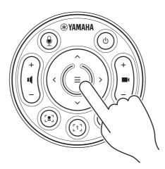
Das Pairing ist abgeschlossen, wenn die Statusanzeige an der Frontblende dieses Geräts 3 Sekunden lang blau geleuchtet hat.
