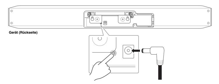
Durch Anschließen des Netzkabels wird dieses Gerät automatisch eingeschaltet.
