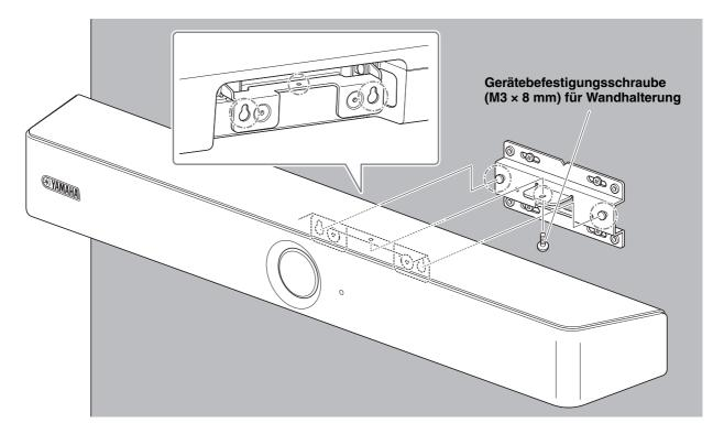
**3.** Befestigen Sie dieses Gerät von der Unterseite der Wandhalterung mit der zugehörigen Befestigungsschraube (M3 × 8 mm).
