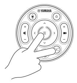
Die Konfiguration ist abgeschlossen, wenn die Statusanzeige auf der Frontblende des Geräts fünfmal im Abstand von 0,5 Sekunden orange geblinkt hat.
