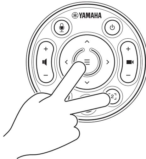
La configuración estará terminada después de que el indicador de estado del panel delantero parpadee en naranja cinco veces con un intervalo de 0,5 segundos.
