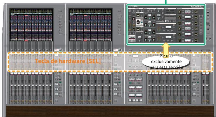
La tecla de hardware [SEL] se usa para seleccionar el canal correspondiente para la sección Selected Channel (hardware). Sin embargo, las teclas [SEL] se pueden enlazar a canales seleccionados en pantalla con el fin de asignar canales a un DCA o grupo de mute.
