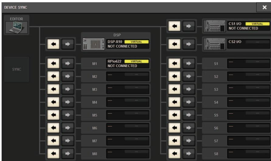
Al conectar PM Editor, debe especificar la dirección de sincronización de los datos del motor DSP.
