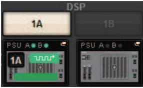
En el caso de una configuración de duplicación de DSP, esta área mostrará un botón para alternar el motor DSP entre activo y en espera además de botones emergentes DSP para dos unidades. En este caso, la ventana emergente SYSTEM CONFIG [DSP] que se abre con el botón emergente DSP será válida solo para el motor DSP seleccionado como unidad activa con el botón activo/en espera.
