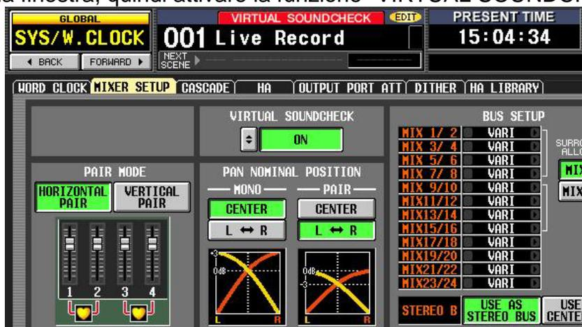
Ora è possibile ascoltare e missare la registrazione sulla console PM5D. Se si disattiva la funzione "VIRTUAL SOUNDCHECK", verranno ripristinate le impostazioni di assegnazione per la SCENE corrente. L'area nella parte superiore della schermata di PM5D indica se la funzione è attivata.
