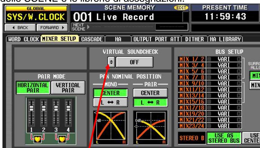
Fare clic sul piccolo pulsante con la freccia per visualizzare la finestra "VIRTUAL SOUNDCHECK SETUP".
