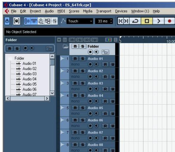
Occorre, quindi, assegnare a ogni traccia un ingresso e un'uscita dall'elenco di bus creato nella finestra "VST Connections". Ovviamente conviene assegnare "Mono In 1" e "Mono Out 1" alla traccia 1, "Mono In 2" e "Mono Out 2" alla traccia 2 e così via. Queste assegnazioni si possono effettuare nella colonna di sinistra della finestra del progetto se il pulsante "Show Inspector" è attivato.
