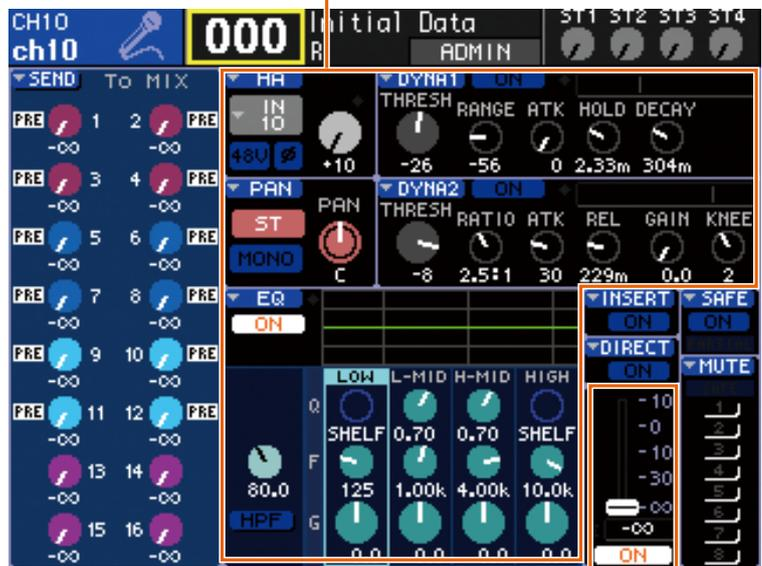
El módulo de canales controla los parámetros que aparecen en esta sección de la pantalla. Corresponde a la sección inferior del módulo de canales de la consola analógica que aparece a la izquierda.
