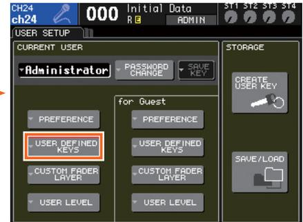
(2) 将光标置于 USER DEFINED KEYS 按钮上并按下 ENTER 键。将会打开 USER DEFINED KEYS 弹出窗口以显示当前的键分配设置。
