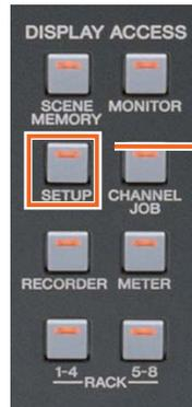
(1) 重复按下 DISPLAY ACCESS 部分的 SETUP 键，直至出现 USER SETUP 显示。
