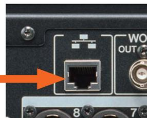
重复按下 DISPLAY ACCESS 部分的 SETUP 键，直至出现 MISC SETUP 显示。MISC SETUP 显示的 NETWORK 区域中应出现 LINK MODE、IP ADDRESS、GATEWAY ADDRESS、SUBNET MASK 和 MAC ADDRESS 参数。请注意，仅支持 C 类 IP 地址（前三位数字为 192 ~ 223）。
