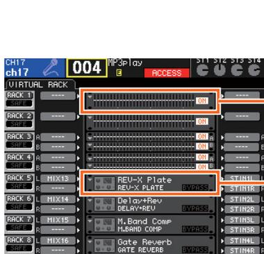
如果选择机架空间 1 ~ 4 中的装置，则将在按下 [ENTER] 键时将打开 EQ 编辑显示。
