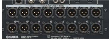
雅马哈的 OMNI 输出端口可由用户分配，即用户可指定通过哪个接口输出信号，可进行灵活的信号通路选择和系统配置。由于输出端口可内部进行分配，因此您可更改输出信号通路而无需实际重新连接电缆。LS9 允许您将任意 16 个 MIX 总线、8 个 MATRIX 总线、立体声输出、非立体声输出、监听输出、甚至输入通道直接输出信号分配至任意 OMNI 输出接口。例如，当将 LS9-16 用于小型实况声音应用时，您可能将两个输出用作驱动剧院系统的立体声主输出、四个 MIX 总线输出用作舞台监听，而一个 MATRIX 总线输出用于馈给化妆室系统。这样即在应用中对八个输出中的七个输出进行了有意义且实用的分配。在类似 LS9 的数字调音台中，提供了所有必要的动态、EQ 和内置效果处理，通过 OMNI OUT 可充分利用可用空间和资源，允许用户自定义调音台的输出配置以满足其实际需要。
