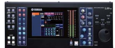
按两次 16 个 MIX/MATRIX 键中的某一个键，所有其他 MIX/MATRIX 键会亮起，而按下的按钮会闪烁。同时，显示器上的“SENDS ON FADER”会闪烁，表示 Sends On fader 模式已激活。
