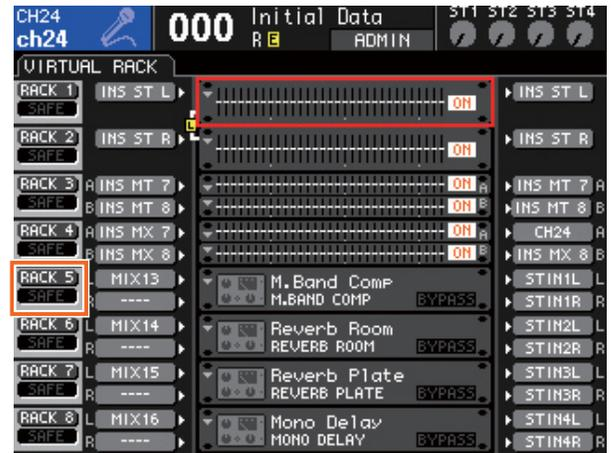
(2) 将光标置于您想要访问的机架所对应的 RACK 按钮，并按下 [ENTER] 键。将会打开 RACK MOUNTER 弹出窗口。
