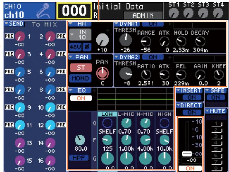
通道模块控制显示器该部分所显示的参数。这对应于左侧所示模拟调音台通道模块的下部。
