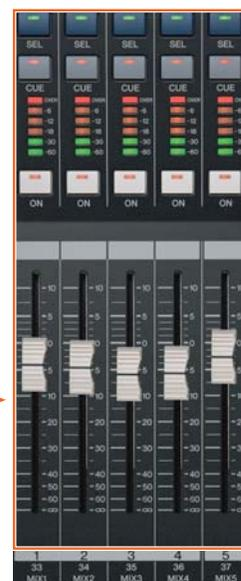
可按相同方法将信号从 MIX、STEREO (L/R) 和 MONO 总线发送至 MATRIX 总线 (显示将有所不同)。
