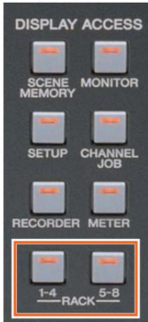
(1) 同时按下 DISPLAY ACCESS 部分的 RACK [1-4] 和 [5-8] 键，可打开虚拟机架 GEQ/ 效果显示。
