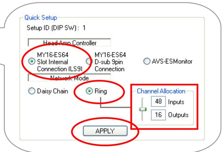
Une fois la confirmation effectuée, le patch du réseau est opérationnel. Le routing de contrôle des préamplis est fait et les informations sont sauvegardées dans les appareils EtherSound. Ainsi, le réseau reste configuré après remise sous tension du système.
