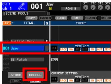
11. Rappelez la scène nécessitant le patch SB168-ES. (les patches IN et OUT ne seront pas rappelés à cause du mode focus, le patch SB168-ES sera donc utilisé).
