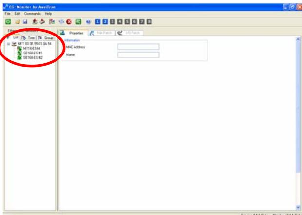
Les appareils connectés sur le réseau EtherSound sont affichés dans la colonne "List".
