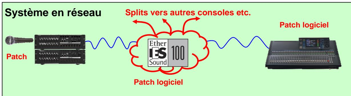
**Utilisez la fonction Quick Setup de AVS-ESMonitor** pour effectuer le patch réseau en une seule étape. Ceci fait, le système fonctionne comme un système numérique traditionnel, sans avoir à modifier quoi que ce soit dans le patch. Mais le fait d'être en réseau vous permettra des extensions futures.
