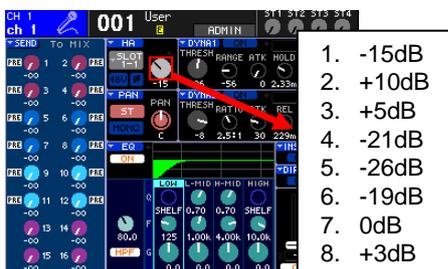
2. Notieren Sie die HA-Werte der Preamps, weil diese nicht automatisch von AD IN auf SB168 HA kopiert werden.
