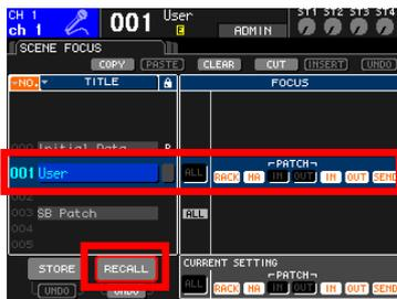
11. Rufen Sie jene Szene auf, welche die SB168-Verpatchung benötigt. (Die IN- und OUT-Verpatchung wird aufgrund der "Focus"-Einstellungen nicht mitgeladen. Stattdessen wird die SB168-Verpatchung benutzt.)
