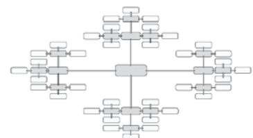
Topologie en étoile (CobraNet™)
