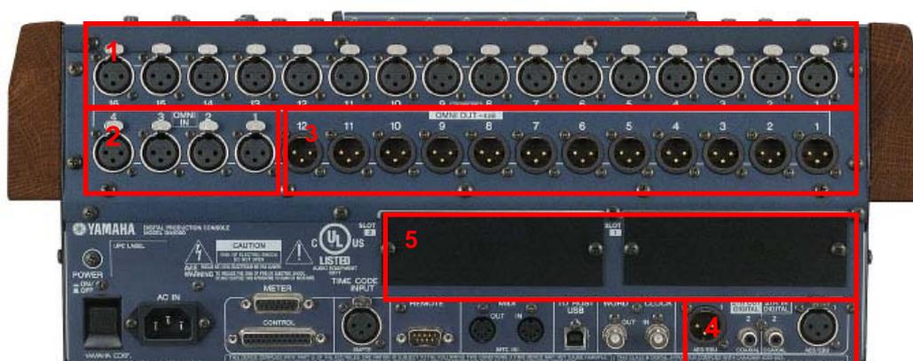
Les autres connecteurs présents sur le panneau arrière servent à diverses fonctions de commande et de synchronisation. Par exemple, le port CONTROL (sur connecteur Sub-D 25 points) est destiné à des relais GPI basse tension. Le port REMOTE sert à contrôler des préamplis micro externes, et le connecteur METER sert au panneau de vumètres optionnel.
