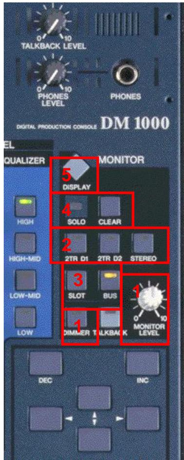
1. Le potentiomètre MONITOR LEVEL sert à régler le niveau de l'écoute principale (cabine). La touche DIMMER permet d'appliquer instantanément une atténuation de 20 dB.
