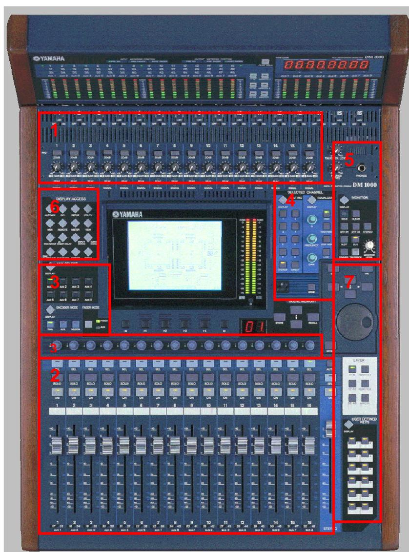
La région assignable, **SELECTED CHANNEL**, repose sur un concept qu'il est fondamental de comprendre. Elle permet d'accéder simultanément à toutes les fonctions importantes d'une voie – une
