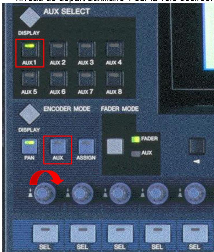
2. Vérifiez que le fader Master du départ auxiliaire 1 est monté, en position 0 dB (sa position par défaut).
