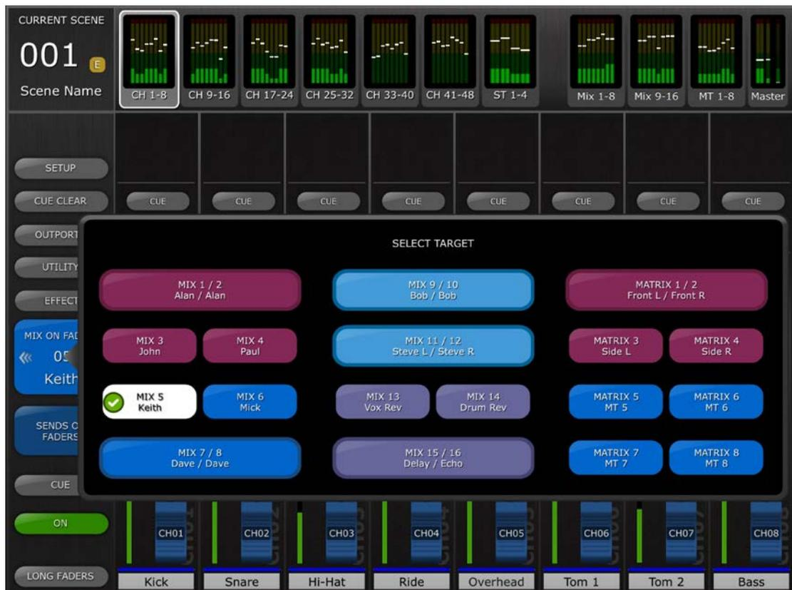
Choisissez le bus de destination parmi les bus Mix 1-16 et Matrix 1-8. Le bus Mix actuellement sélectionné s'affiche sous forme d'une touche blanche contenant une coche. Les paires stéréo apparaissent sous forme de grandes touches simples (sans coche).
