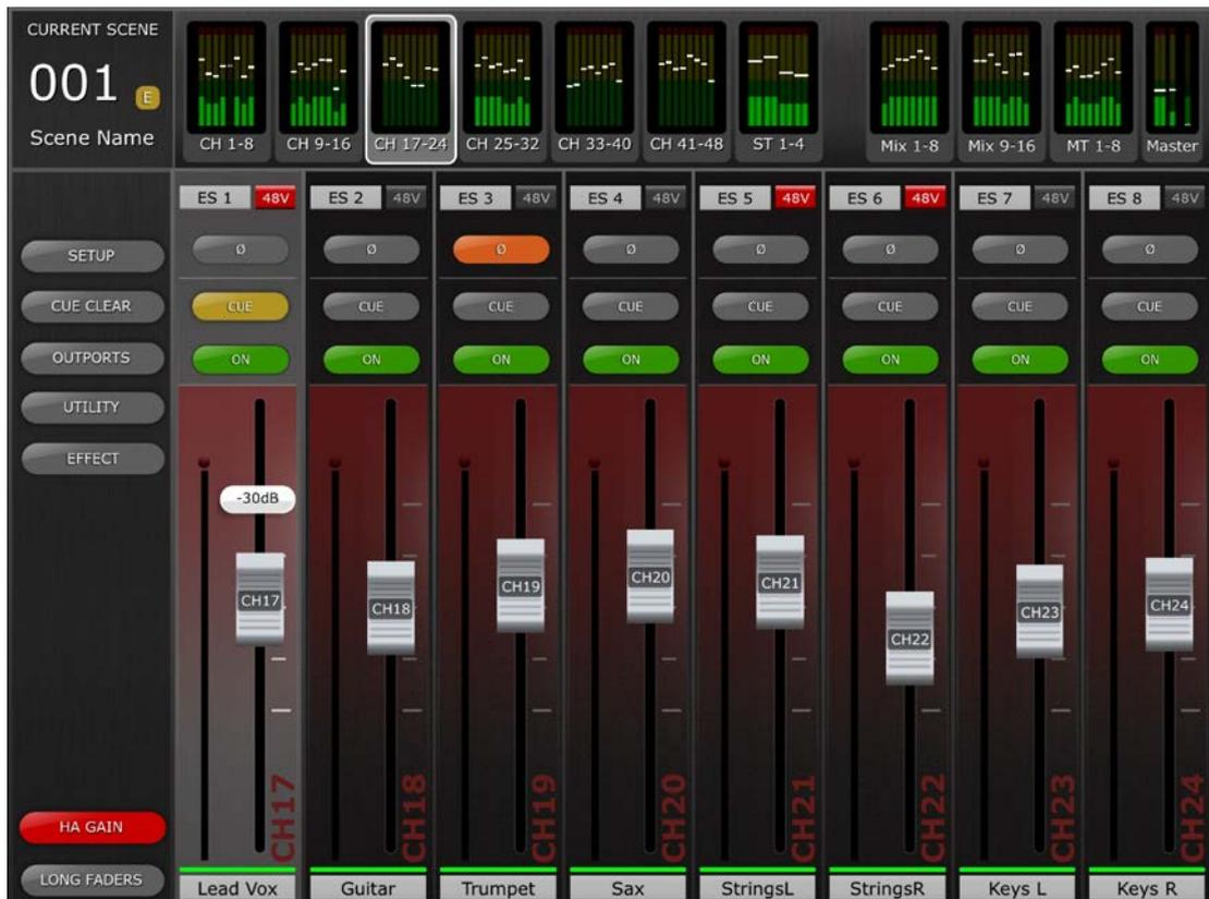
Vous pouvez déplacer les faders pour modifier le réglage HA Gain sur les canaux correspondants. La valeur de gain de chaque préampli micro s'affiche au dessus du fader concerné dès que vous en touchez le capuchon. Il est possible de régler un maximum de 8 faders en simultanément.
