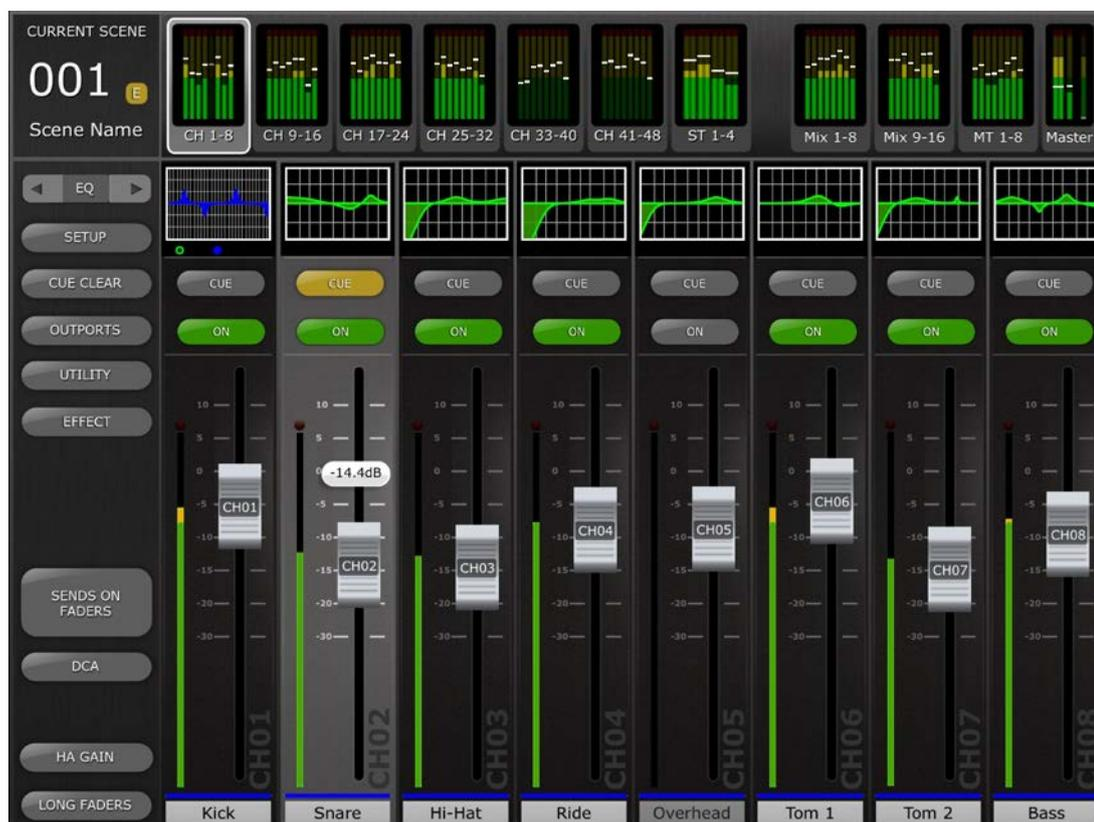
Dans la partie supérieure de l'écran, les indicateurs de niveau et les faders s'affichent par blocs de canaux correspondant respectivement aux canaux d'entrée mono 1-48, aux canaux d'entrée stéréo 1-4, aux bus Mix et Matrix ainsi qu'aux bus master stéréo et mono. Il s'agit de ce qu'il est convenu d'appeler « Navigation/Meter Bridge » (Navigation/Bandeau de bargraphes).
